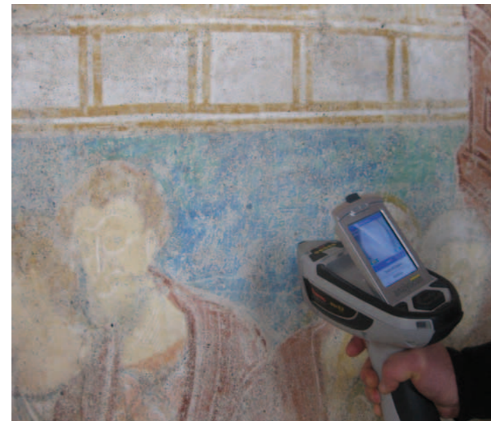
Südwand, Untersuchung zu Pigmentveränderungen mittels Röntgenfluoreszenzanalyse (RFA)
