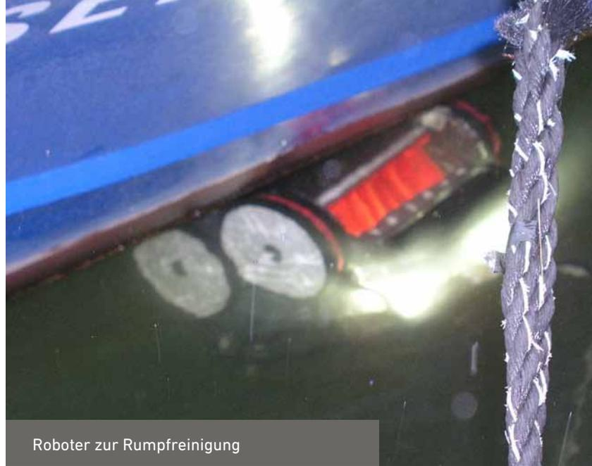
Roboter zur Rumpfreinigung
