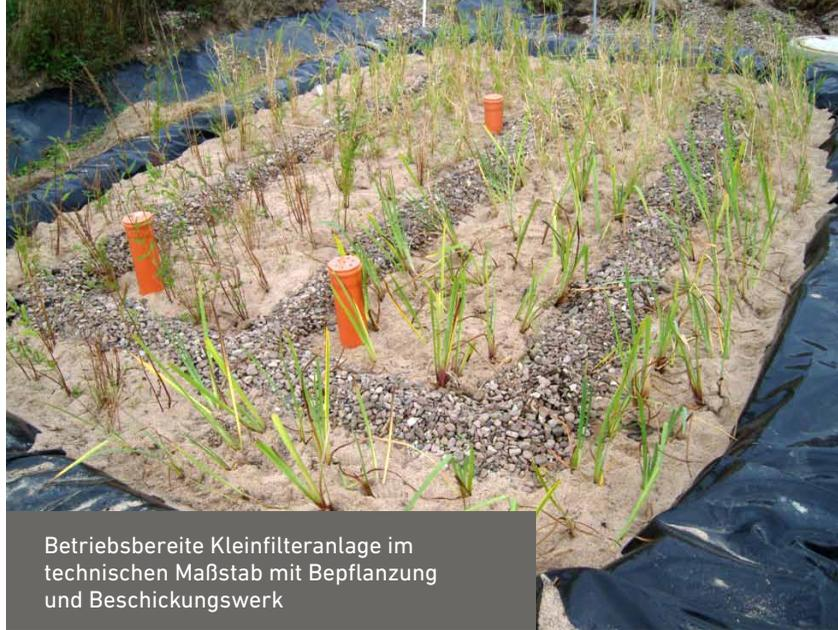
Betriebsbereite Kleinfilteranlage im technischen Maßstab mit Bepflanzung und Beschickungswerk
