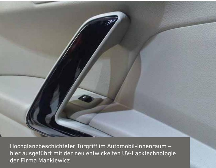
Hochglanzbeschichteter Türgriff im Automobil-Innenraum – hier ausgeführt mit der neu entwickelten UV-Lacktechnologie der Firma Mankiewicz
