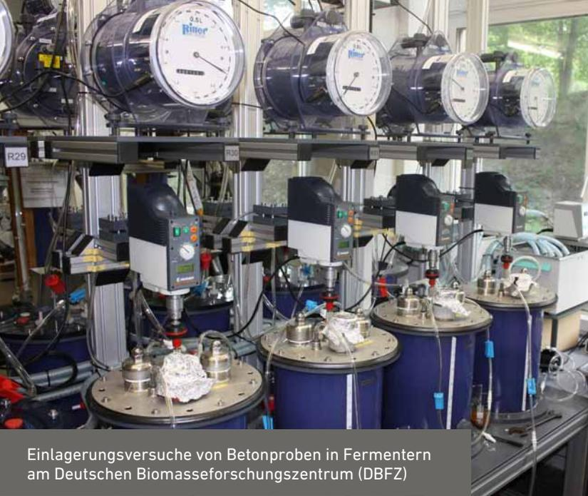
Einlagerungsversuche von Betonproben in Fermentern am Deutschen Biomasseforschungszentrum (DBFZ)
